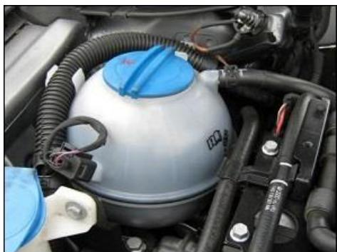
Le liquide de refroidissement a la particularité de ne bouillir qu'au-delà de 100°C et, pour qu'il gèle, les températures doivent être très basses. Il a donc pour premier rôle de maintenir une constance dans la température du moteur en évitant les surchauffes mais aussi en empêchant l'eau de geler.
