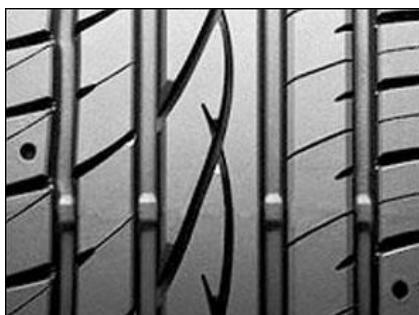
La **profondeur des rainures** principales d'un pneu doit être d'au moins **1,6 mm**. Mais à cette profondeur, la sécurité de conduite n'est plus assurée, car avec une profondeur de moins de 2 mm vous risquez déjà de faire de l'aquaplaning.
