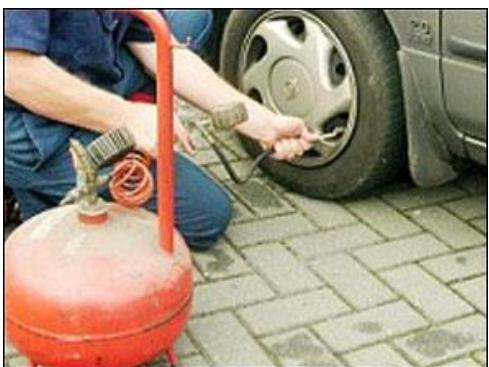
La pression des pneus doit correspondre aux **indications** du constructeur.
