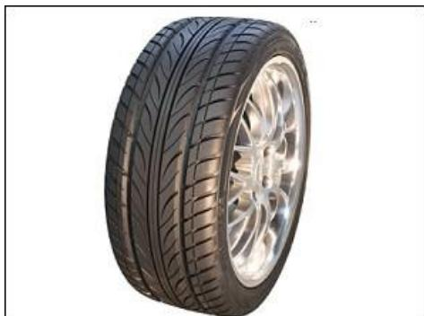
Les pneus sont le seul contact entre le véhicule et le sol. Pour freiner en toute sécurité, les pneus d'une voiture doivent être en bon état. Divers témoins d'usure sont situés dans les rainures principales de vos pneus. Si la bande de roulement, en s'usant, arrive à hauteur de ces témoins de contrôle (TWI) vos pneus sont trop usés. Il faut les changer avant. (voir leçon 31)
